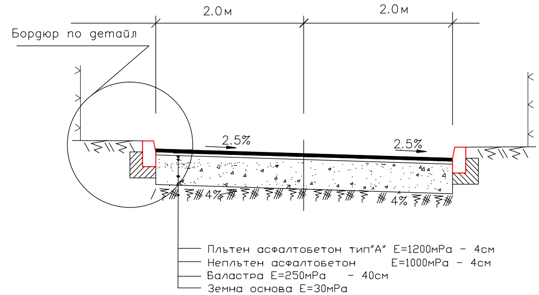
ТИПОВ НАПРЕЧЕН ПРОФИЛ 2 КЛОН2-км0.+170-км0+258.33 М 1:50
